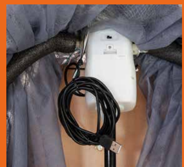
Batteriebox mit Auslöser und USB-Stromanschluss
